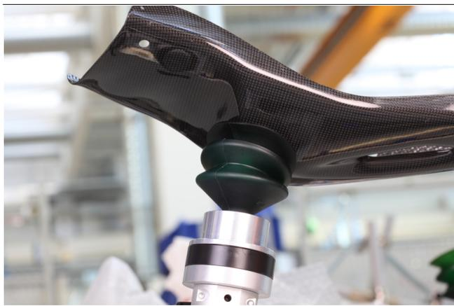
Uni-Base UB und Reference-Cup RSC beim Aufspannen eines CFK-Bauteils
